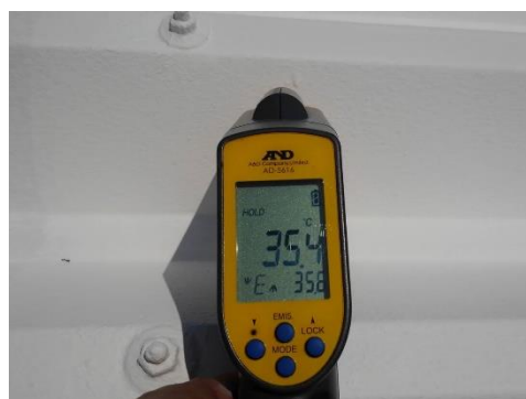
遮熱塗料施工後 折板温度 : 35.4℃
